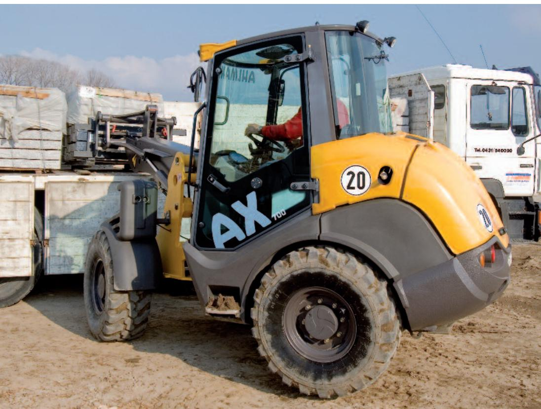
Le bras mono-boom de l'AX apporte une force d'arrachement élevée. La cinématique en Z permet un levage parallèle performant et le chargement de palettes en toute sécurité. Des cycles de travail courts et une excellente visibilité sur les accessoires rendent le travail plus productif.
