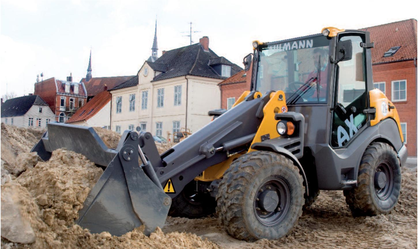
La cabine est spacieuse avec des commandes disposées ergonomiquement et offrant un cadre de travail agréable. Les grandes vitres teintées offrent une visibilité panoramique. Le toit partiellement vitré facilite le déversement dans une benne de camion.
