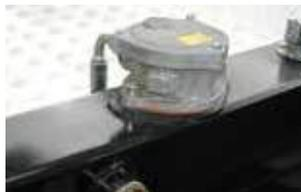
↘ Réservoir hydraulique intégré directement dans le châssis
