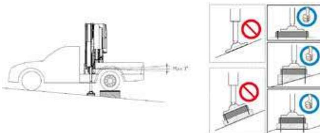
Uniquement 2 pieds stabilisateurs. Ce qui permet une installation rapide. De plus, le fait de garder les 4 roues au sol simplifie le levage (contrôler toujours que l'inclinaison du châssis ne soit pas supérieure à 1° d'inclinaison longitudinale et transversale)
