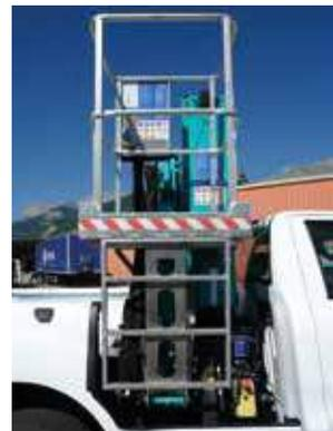
Le positionnement de la nacelle au centre du véhicule lui permet d'avoir un bon équilibre et donc un bon comportement routier.
