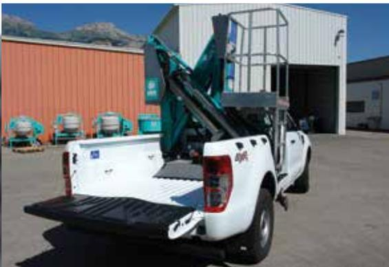
Mise à part la hauteur du véhicule en ordre de marche qui passe à 2.60 m, on garde le gabarit d'origine du véhicule y compris la caisse arrière que l'on peut fermer par un coffre ce qui permet de circuler avec un outillage en toute sécurité.
