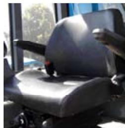
SIÈGE RÉGLABLE AVEC SUSPENSION ET ACCOUDOIR(S)
