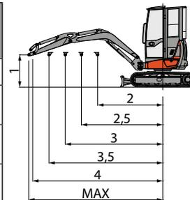
La capacité de levage est basée sur la norme ISO 10567 est elle ne dépasse pas au-delà du 75% du charge statique de basculement ou au-delà du 87% de la capacité de levage hydraulique de la machine.
