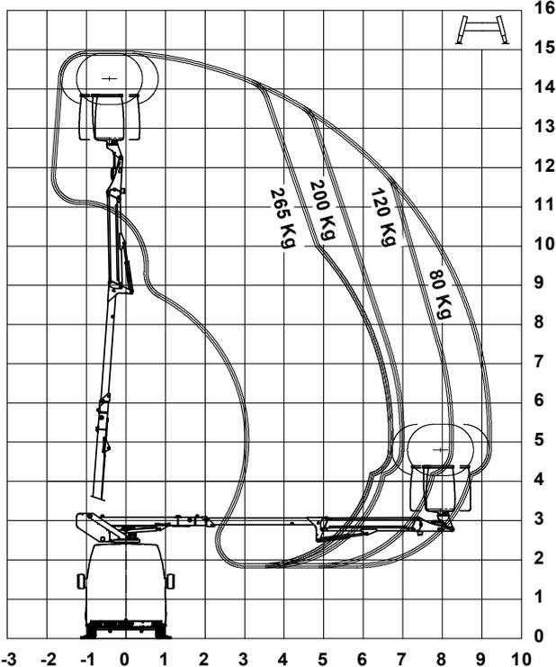
La présence d'une **armature tubulaire** permet de conserver 90 % du volume d'origine tout en facilitant l'accès par la porte latérale. Ce dispositif **est unique sur marché** et il contribue à optimiser la performance de ce modèle 152 TPF aux capacités de charge panier importantes (265 kg) .
